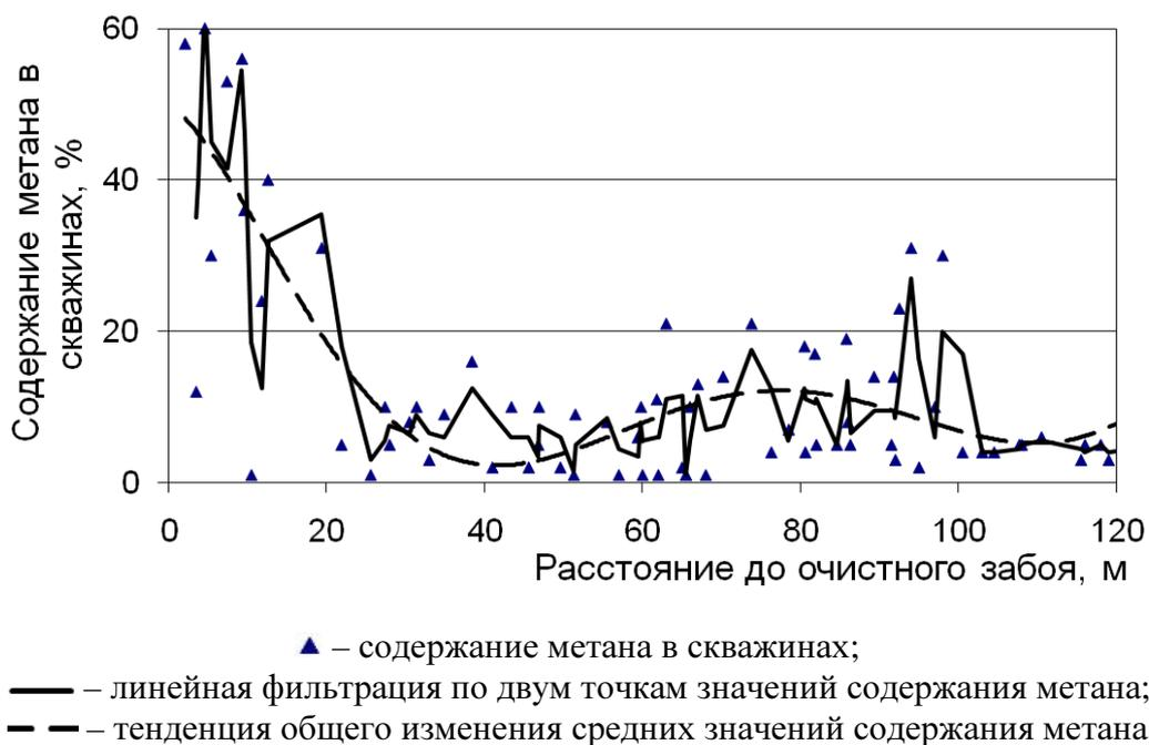
Рис. 2 – Изменение содержания метана в дегазационных скважинах вдоль вентиляционного штрека в зависимости от расстояния до очистного забоя
